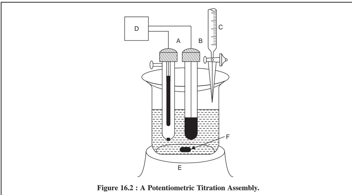
**Figure 16.2 : A Potentiometric Titration Assembly.**
