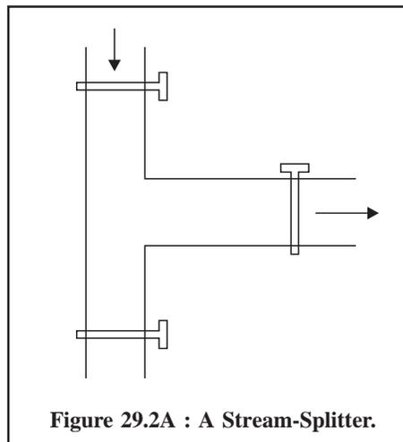
**Figure 29.2A : A Stream-Splitter.**
