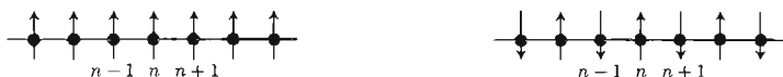
Figure 30.46: À gauche : ce que serait l'état fondamental avec des spins classiques. À droite : ce que peut être l'état fondamental quand on imagine le réseau d'atomes comme une juxtaposition de dimères dans leur état fondamental.
