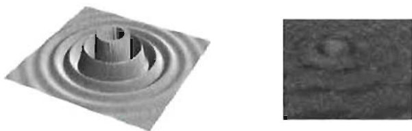
Figure 26.7: Oscillations de Friedel : à gauche, tracé numérique de \delta\rho , (26.23). À droite, image par microscope à effet tunnel de la surface d'un métal autour d'une impureté.
