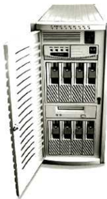
Figure 13.8 Une baie de stockage RAID
