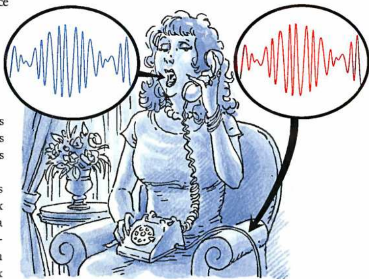
1 Dans un téléphone classique, les variations de pression associées à l'onde sonore (en bleu) sont converties en un signal électrique (en rouge) qui varie de la même façon.
