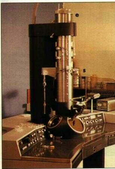
9 Le microscope électronique. Un microscope électronique avec le canon à électrons (e) au sommet de la colonne, la platine de l'échantillon (s) et l'écran fluorescent (f).
